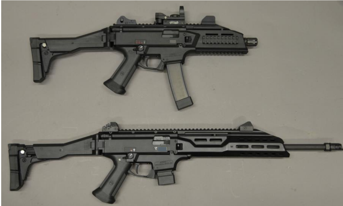
Abbildung 120: Oben vollautomatische Maschinenpistole CZ EVO 3A1, Kal. 9mmLuger, Kriegswaffe, darunter die halbautomatische Büchse CZ EVO 3 S1, Kal. 9mmLuger
