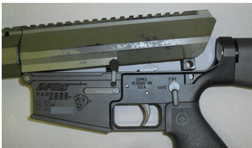
Abbildung 74: Das Gehäuseoberteil der Vorderschaft- Repetierbüchse Troy Defense PAR lässt sich auf das untere Gehäuse der halbautomatischen Büchse DMPS Modell LR-243, Kal. .243Win montieren.
