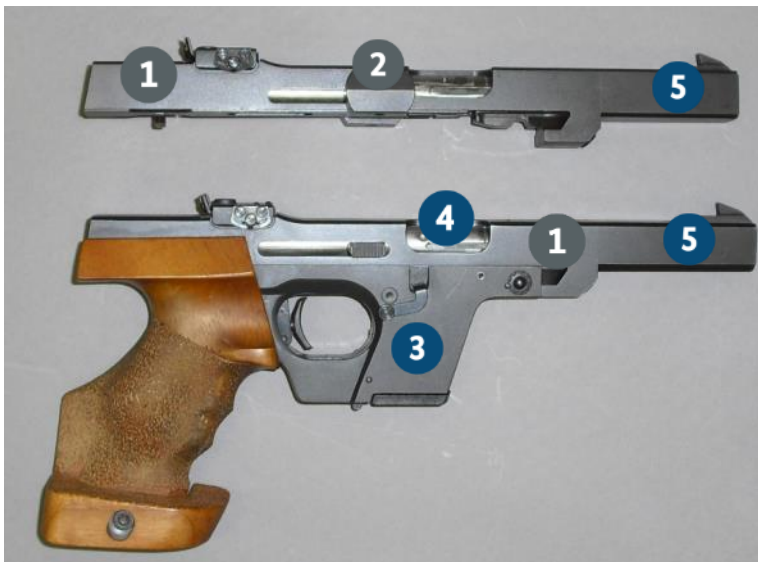
Abbildung 27: Halbautomatische Pistole Walther GSP, Kal. .22lr Ansicht rechte Seite. Im Bild oben ein Wechselsystem für diese Pistole.
