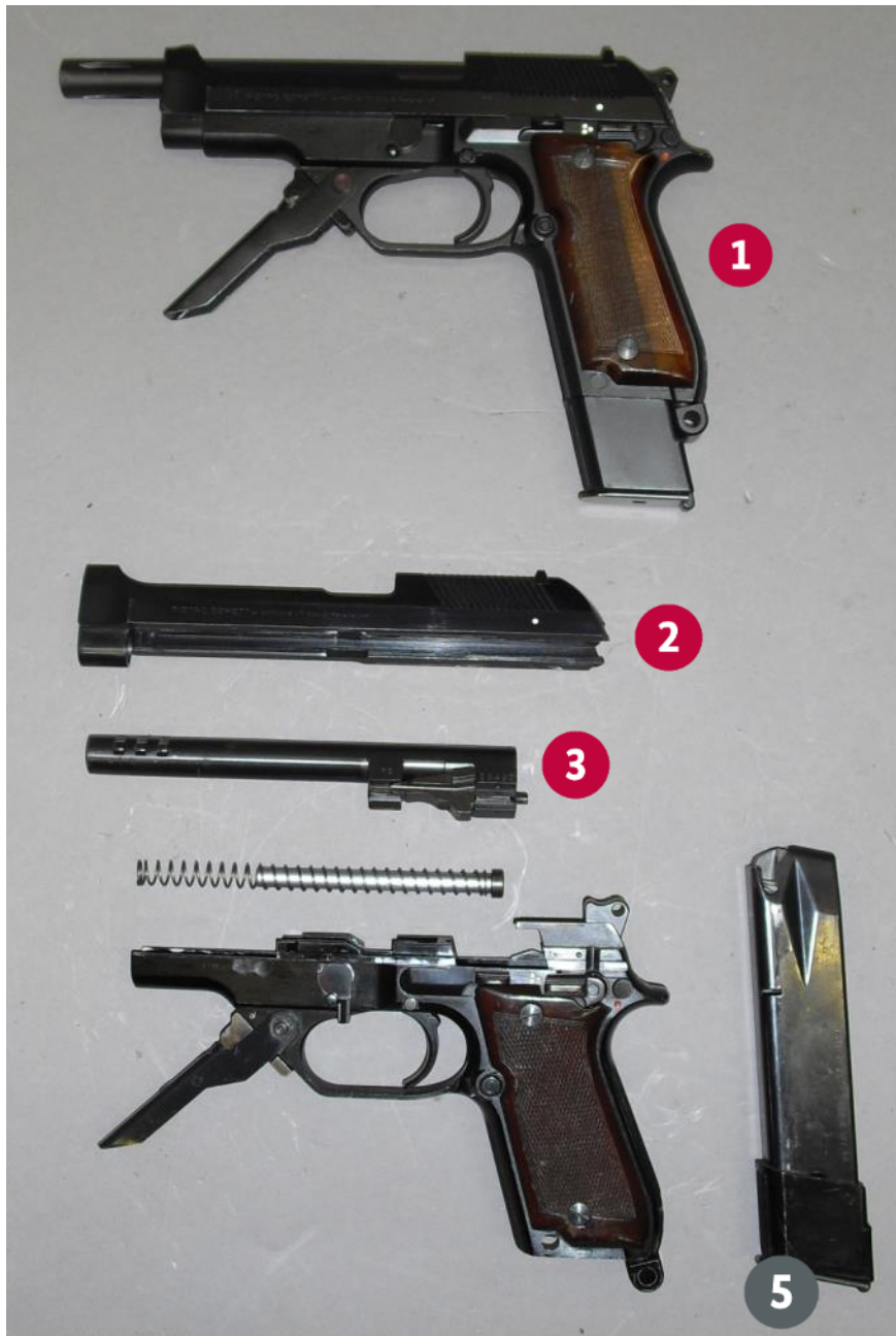
Abbildung 14 Vollautomatische Pistole Beretta Modell 93 R, Kal. 9mm Luger, oben die vollständige Waffe, unten zerlegt.
