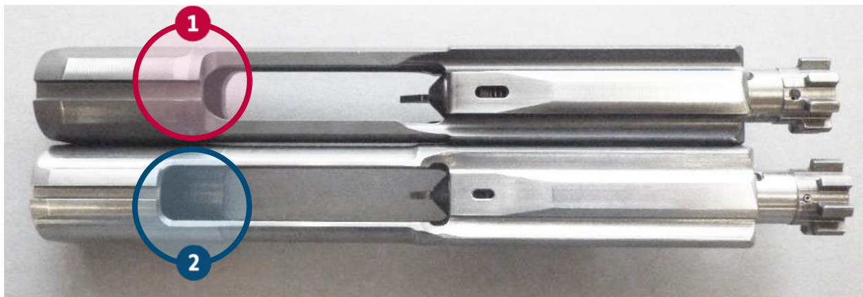
Abbildung 80 Oben Baugruppe Verschluss Heckler & Koch Modell 416, Kriegswaffe i. S. d. Nr. 35 KWL unten Baugruppe Verschluss Heckler & Koch MR 223
