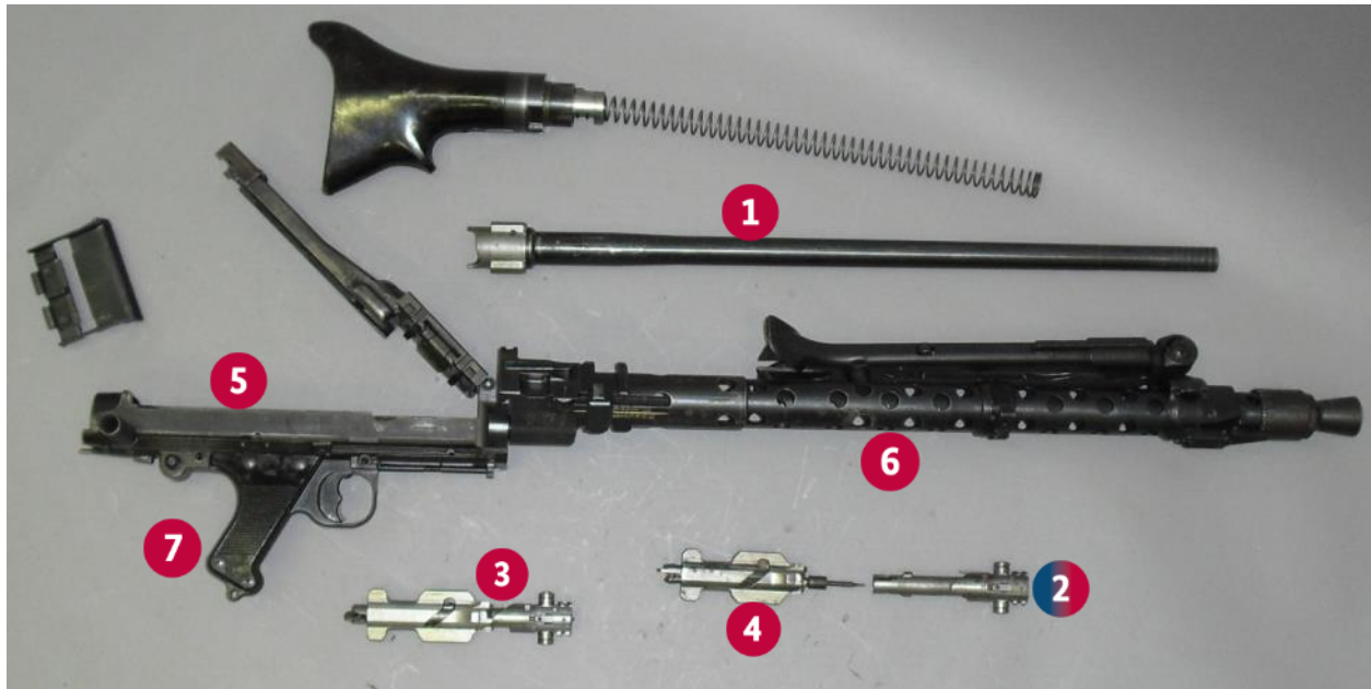
Abbildung 126: Maschinengewehr MG 34, zerlegt zum feldmäßigen Reinigen.
