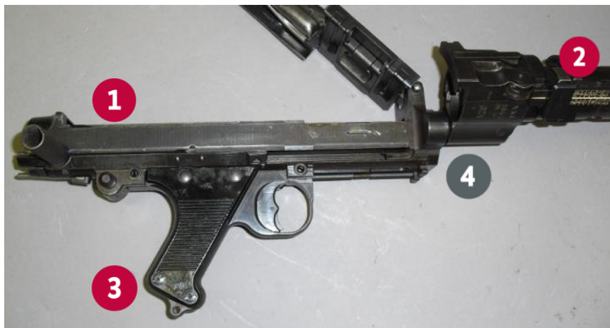
Abbildung 127 Maschinengewehr MG 34, Details des teilbaren oberen Gehäuses, vorderes Teilstück ausgeschwenkt.
