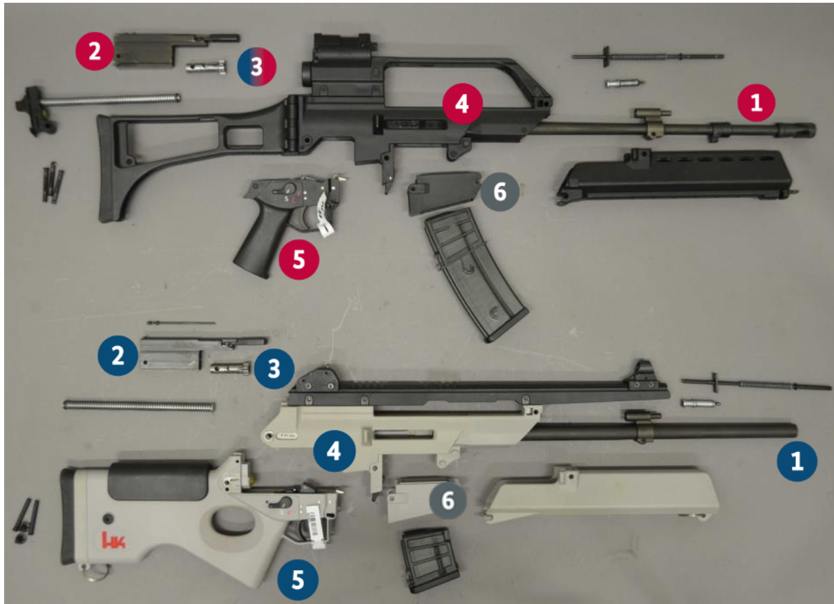
Abbildung 115: Oben vollautomatische Büchse Heckler & Koch Modell G 36, Kaliber 5,56x45., unten halbautomatische Büchse Heckler & Koch, Modell SL 8, Kaliber .223Rem. Der grundsätzliche Aufbau des HK SL 8 findet sich auch beim HK CR 36.
