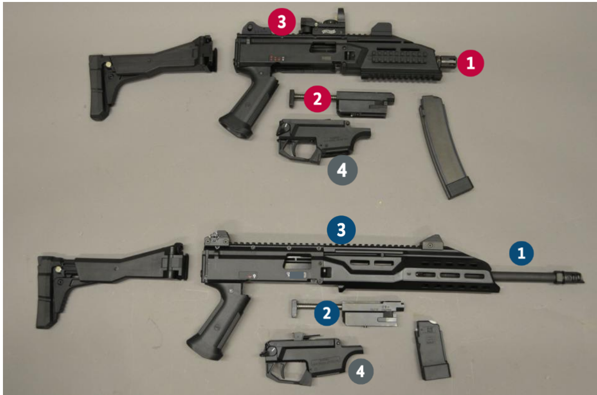
Abbildung 121: Oben vollautomatische Maschinenpistole CZ EVO 3 A1, Kal. 9mmLuger, unten die halbautomatische Büchse CZ EVO 3 S1, Kal. 9mmLuger, zerlegt.
