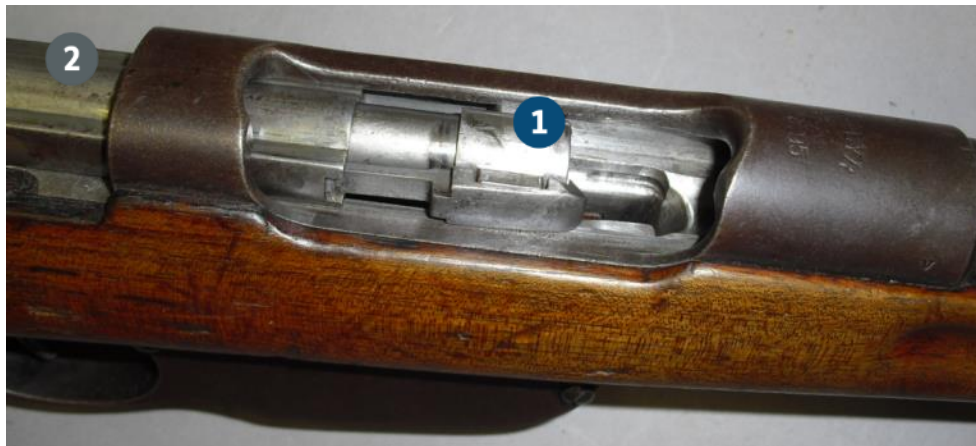
Abbildung 41: Drekkopf des Geradezug-Verschlusses Gewehr Steyr-Mannlicher Modell M 95 komplett.
