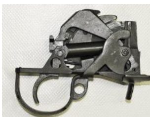
Abbildung 7 Abzugsgruppe eines Springfield Armory Gewehres M1 A oder M 14. Die Rechtsauffassung hat sich geändert! Kein geteiltes Gehäuse und auch kein führendes Waffenteil!
