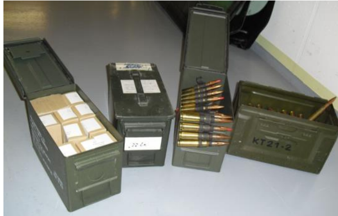
Abbildung 129: Verschiedene Metallkisten, die sowohl für Munitionsgurte als auch für Patronenschachteln verwendet werden.
