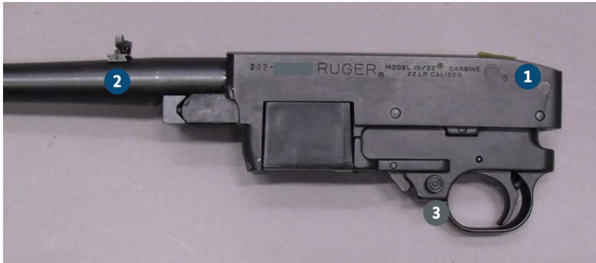
Abbildung 67 Halbautomatische Büchse Ruger Modell 10/22 System entnommen, linke Seite mit Beschriftung auf dem Gehäuse, Magazin eingeführt.
