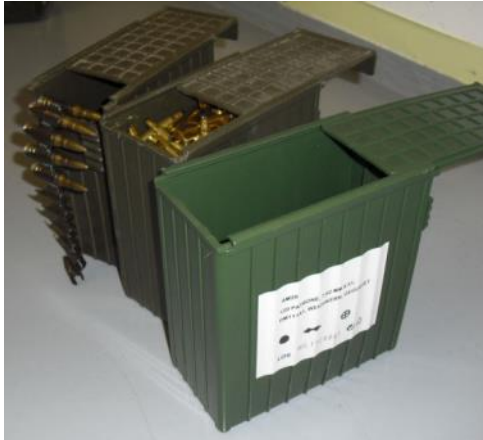
Abbildung 128: Gurtkästen für MG 3. Die Behälter sind universell einsetzbar.
