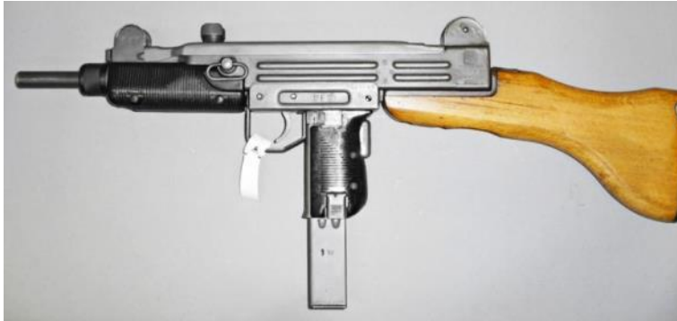
Abbildung 116 Maschinenpistole UZI mit Holz-Schaft, Ansicht linke Seite
