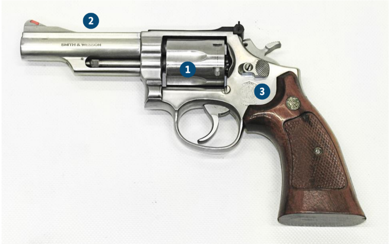
Abbildung 30 Moderne Revolver für Patronenmunition Bezeichnung der wesentlichen Waffenteile
