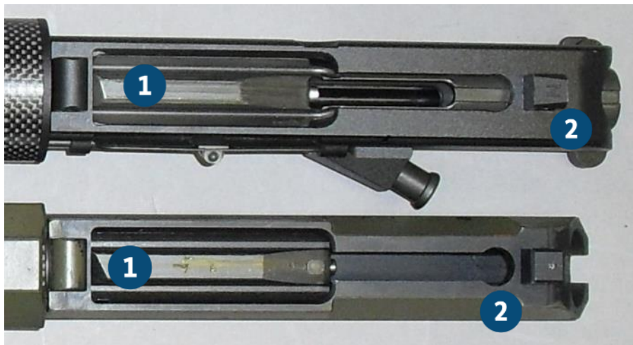
Abbildung 72: Oben oberes Gehäuse und Verschluss halbautomatische Büchse DMP5 Kal. .243Win. unten oberes Gehäuse und Verschluss/-kopf Troy Defense PAR
