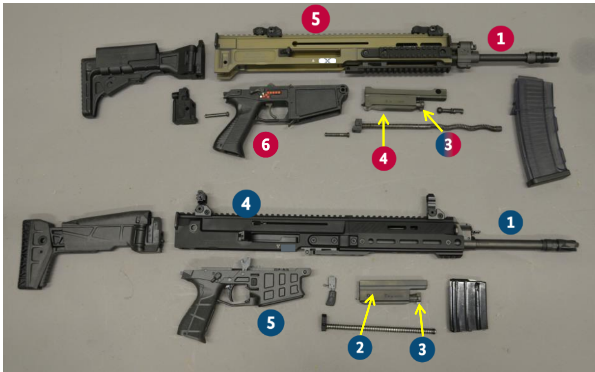
Abbildung 119: Oben, vollautomatische Büchse CZ 805 BREN, unten halbautomatische Büchse CZ BREN 2Ms, zerlegt in einzelne Bauteile
