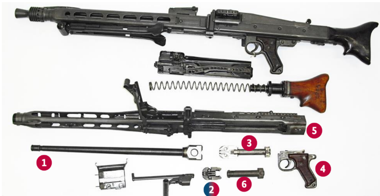
Abbildung 122 Maschinengewehr MG 42/MG 3 zusammengefügt als komplette vollautomatische Kriegswaffe und in zerlegtem Zustand als Einzelteile
