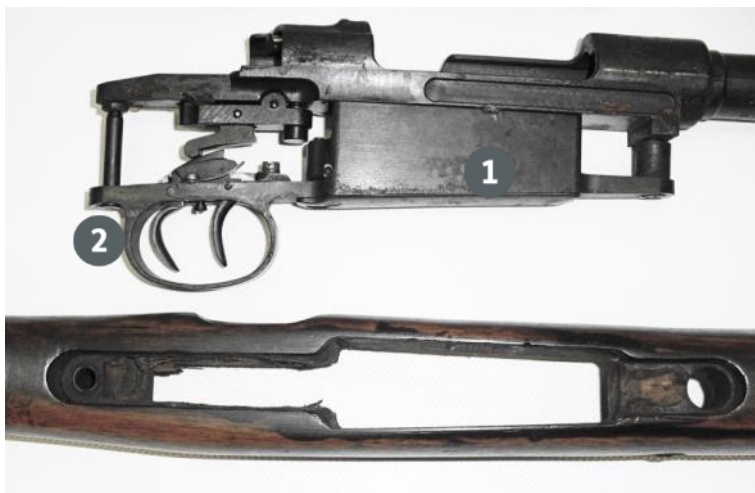
Abbildung 35 Gewehr 98 mit deutschem Stecher. Die Abzugsmechanik ist sowohl auf der Platte am Abzugsbügel als auch an der Systemhülle befestigt.
